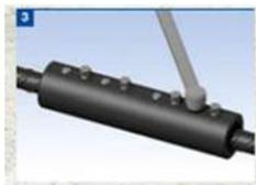
پیچ های قفل برشی را با استفاده از آچار ضامن دار یا چرخاننده مهره به طور کامل سفت کنید. از ابزار ضربه ای استفاده نکنید. همه پیچ ها را به صورت تصادفی و متناوب ببندید تا سر همه پیچ ها جدا شود.
