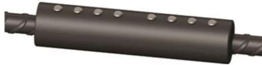
در مکانهایی مناسب هستند که آماده کردن انتهای میلگرد برای رزوه های موازی مناسب نباشد. آنها را می توان بدون هیچ گونه آمادگی روی انتهای میلگرد و بدون نیاز به چرخاندن میلگرد ها نصب کرد. کوپلر را می توان چرخاند تا امکان دسترسی به پیچ ها را برای سفت کردن با آچار ضامن دار فراهم کند.
