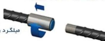
کوپلر را به پشت رزوه روی میله ثابت پیچ کنید و محکم قفل کنید. انتهای میله باید در مرکز کوپلر باشد.
